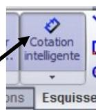
6/ Ajoutez les cotes pour positionner le perçage. Vous pouvez aussi modifier le diamètre du perçage dans l'esquisse.
