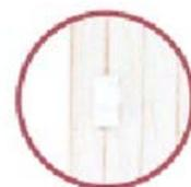
Poignée de porte faite en faisant fondre l'extrémité d'une tige en plastique avec une flamme.
