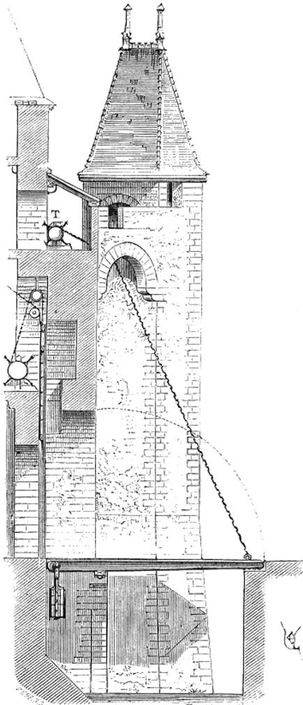
Ce type de pont-levis est une variante du pont-levis à flèches et à chaines.
