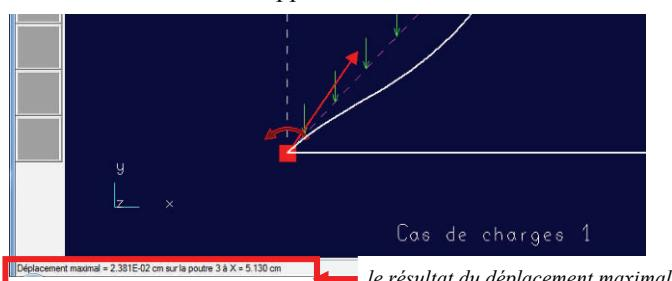
16/ Pour connaître le déplacement maximal, symbolisé par une croix blanche, cliquer sur « Résultats » puis sélectionner « Déplacement maximal »
